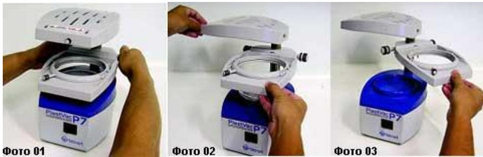
Оправка для моделей имеет две рабочих позиции: в виде стакана и в виде плоского поддона.
