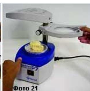
7.2.3 Повторите пункт 7.2.2 однако теперь поверните большее кольцо по часовой стрелке, чтобы вернуть рамку (04) и термопластичную пластину в исходное положение и вновь нагрейте эту сторону пластины но уже более продолжительное время, чем раньше, чтобы довести пластину до состояния текучести. Затем выполните действия начиная с пункта 7.1.11 до завершения процесса вакуумной формовки.
